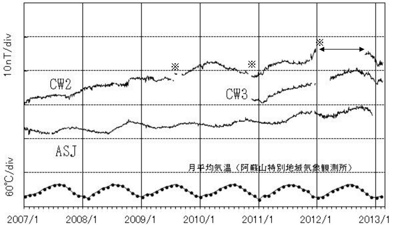
図 11 阿蘇山 阿蘇山麓(AHK)を基準とした阿蘇中岳火口周辺の全磁力変化、及び阿蘇山特別地域気象観測所における月平均気温（2007年1月～2013年2月）
