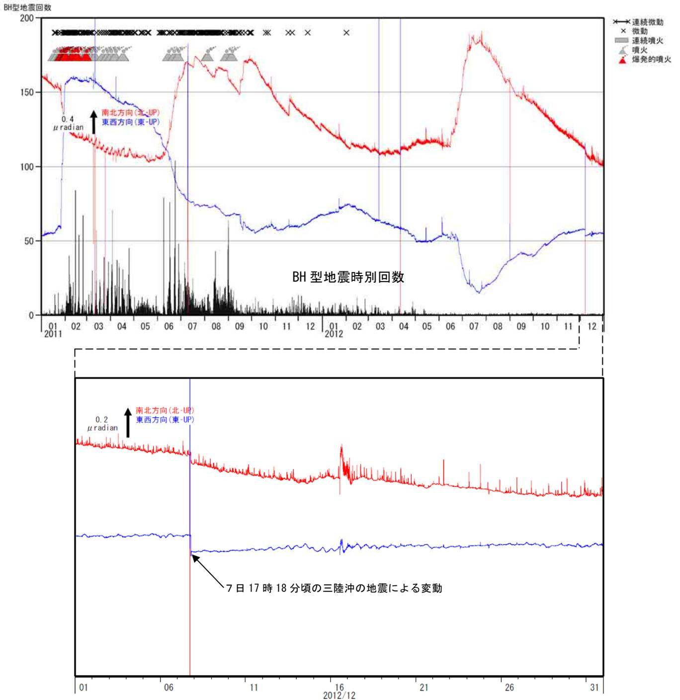
図3 霧島山（新燃岳） BH型地震の時間別回数と高千穂河原傾斜計の変化
