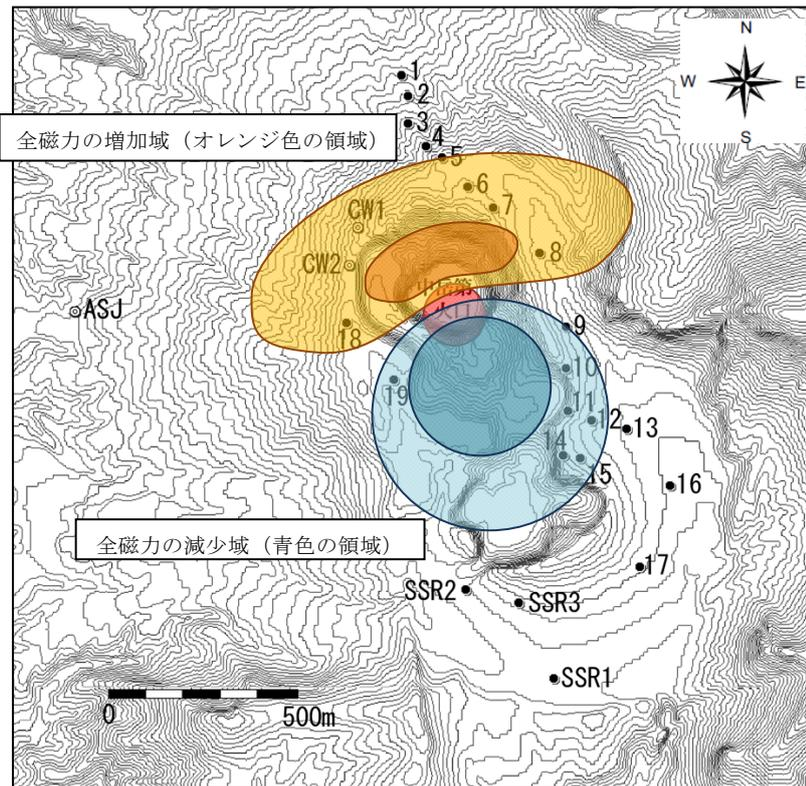
図 8 阿蘇山 【参考】中岳第一火口の熱消磁と全磁力変化パターン
