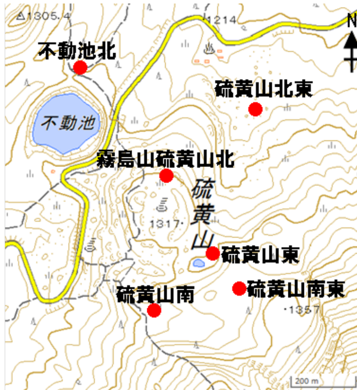
第1図 硫黄山周辺の全磁力連続観測点の配置図（この地図の作成には国土地理院の電子地図（電子国土Webサービス）を使用した）
