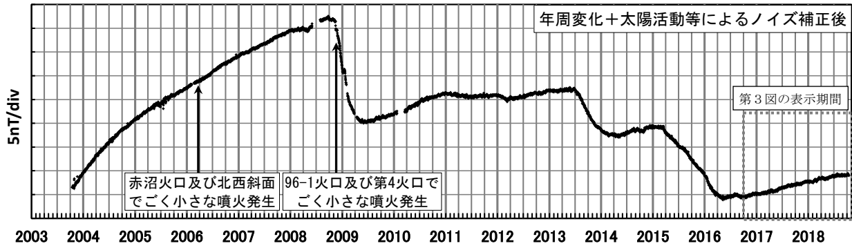
第2図 ポンマチ南東と女満別観測施設の全磁力日平均値差 (2003年10月16日～2018年10月15日) 年周変化補正と太陽活動等によるノイズ補正を行っている。
