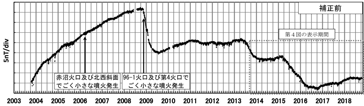
第5図 ポンマチ南東と女満別観測施設の全磁力日平均値差（2003年10月16日～2018年10月15日） 年周変化補正と太陽活動等によるノイズ補正を行っていない。
