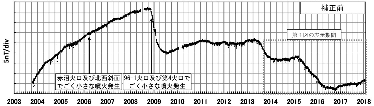
第5図 ポンマチ南東と女満別観測施設の全磁力日平均値差 (2003年10月16日～2018年1月24日) 年周変化補正と太陽活動等によるノイズ補正を行っていない。
