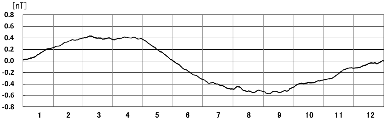
第3図 MEAとMMBの全磁力日平均値差の年周変化(2005~2007, 2011年の1~12月のデータから求めた30日移動平均値)
