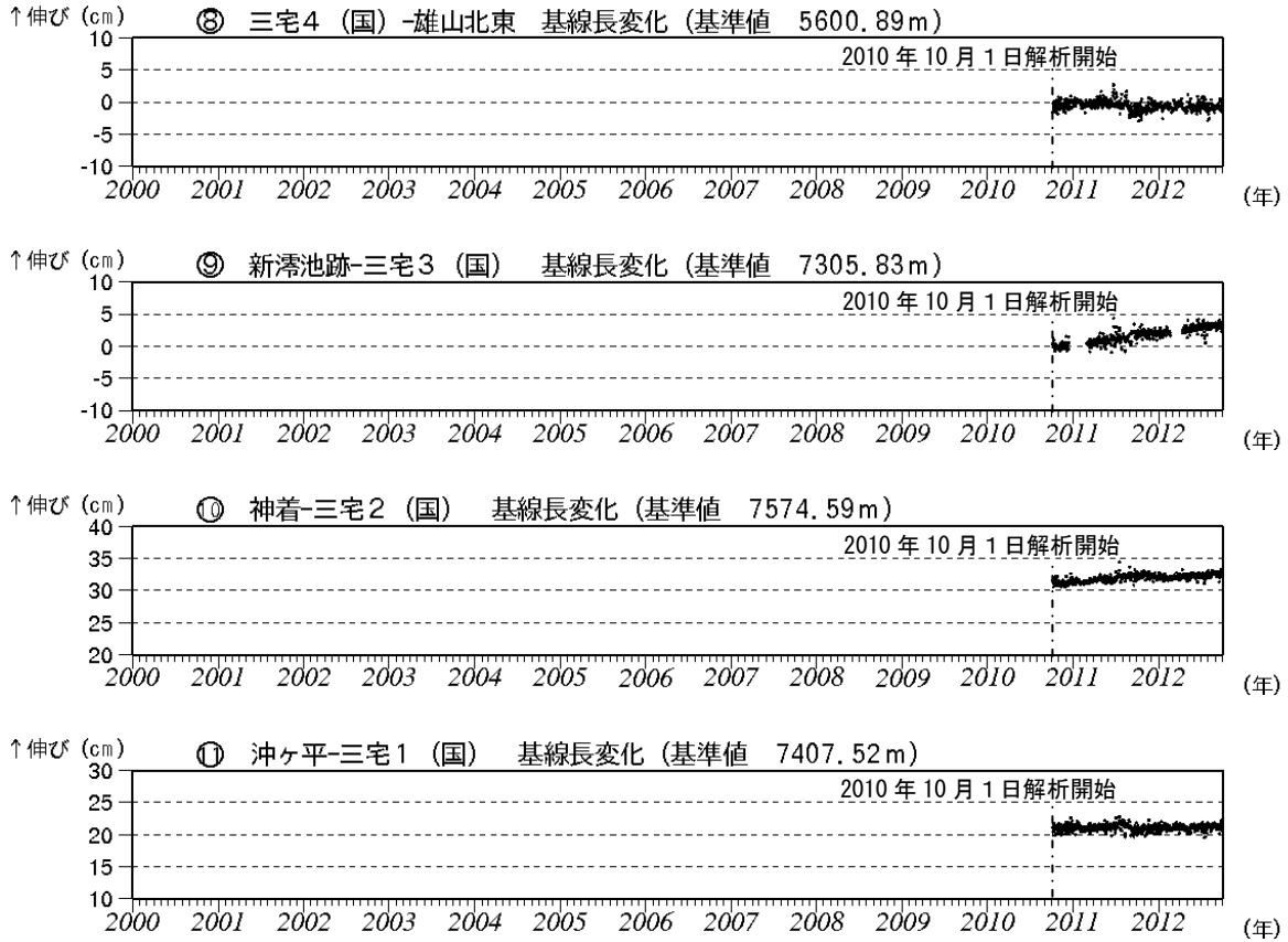
第8図*—② 三宅島 GPS連続観測による基線長変化 (2000年10月～2012年9月30日)
