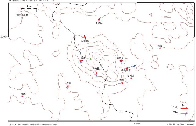
第5回 GPS 連続観測点における地殻変動データから推定した霧島山の変動源モデル(2011 年 2 月~2011 年 5 月)
