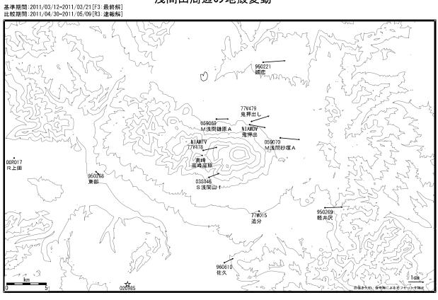
\*<sup>固定局: 望月(020985)</sup> ※[R3:速報解]は暫定値、電子基準点の保守等による変動は補正済み 第5図 浅間山周辺における GEONET 観測点の水平変動ベクトル図(2011年3月~2011年5月)
