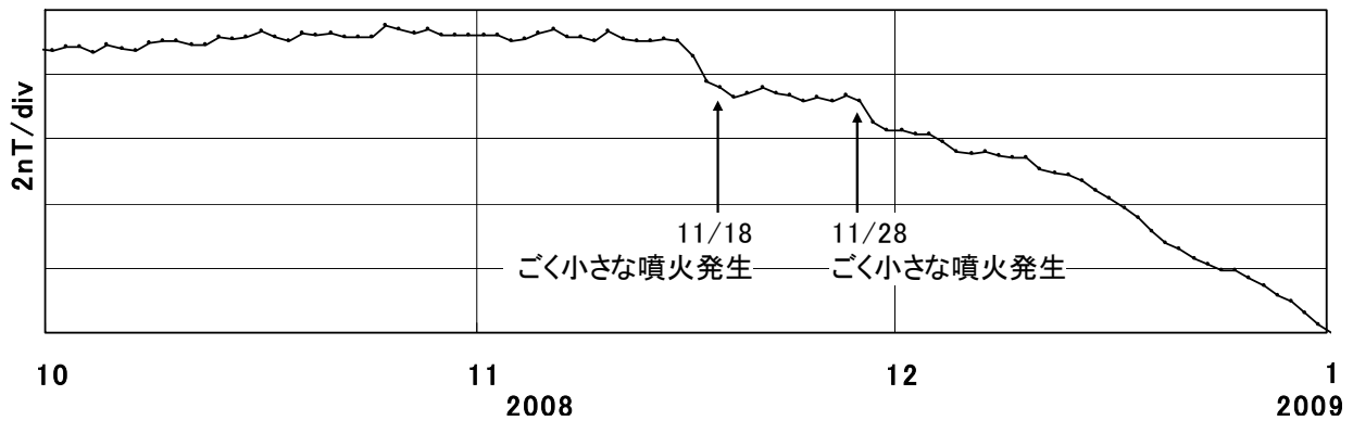
第4図 MEA の全磁力変化から、MMB の全磁力及び地磁気 3 成分（南北、東西、鉛直）を参照して確率差分法により広域 的変動を除去した残差（2008 年 10 月～2008 年 12 月）
