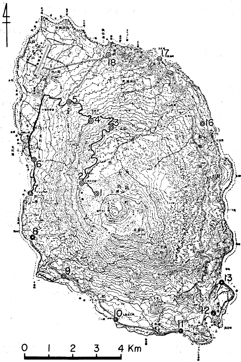
第1図 伊豆大島における水準点の位置 実線は1974年再測路線
