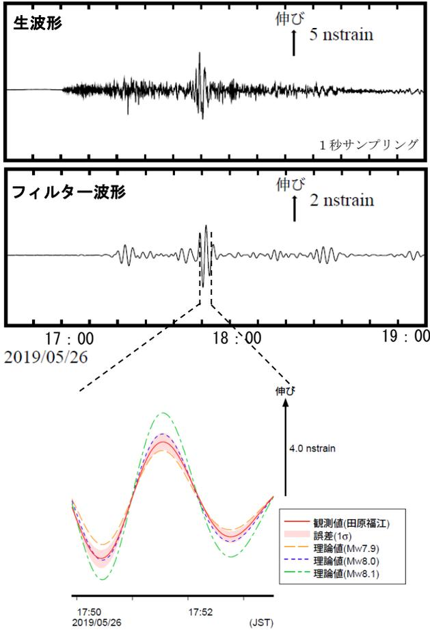
田原福江観測点の観測波形と理論波形の振幅比較 (上図)
