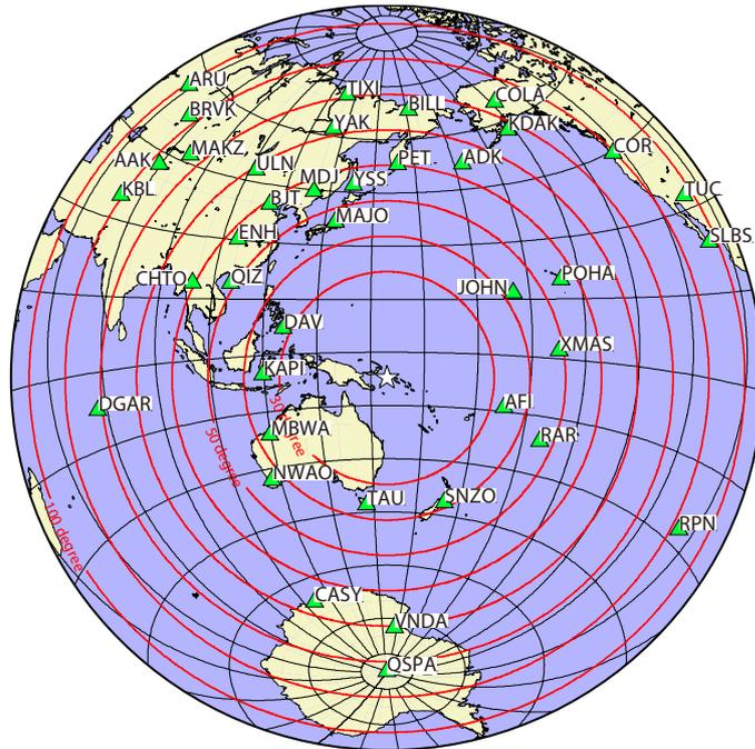
震央距離  $30^\circ \sim 100^\circ$  ※<sup>1</sup> の 39 観測点※<sup>2</sup> (P 波 : 39、SH 波 : 5) を使用。
