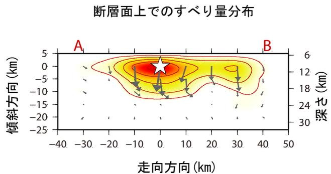
星印は初期破壊開始点、矢印は下盤側に対する上盤側の動きを表す。
