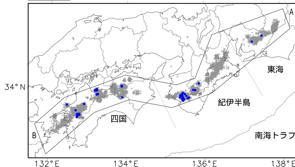
震央分布図の黒の実線は、短期的ゆっくりすべりに伴う深部低周波地震（微動）が定常的に観測されている領域を示す。
