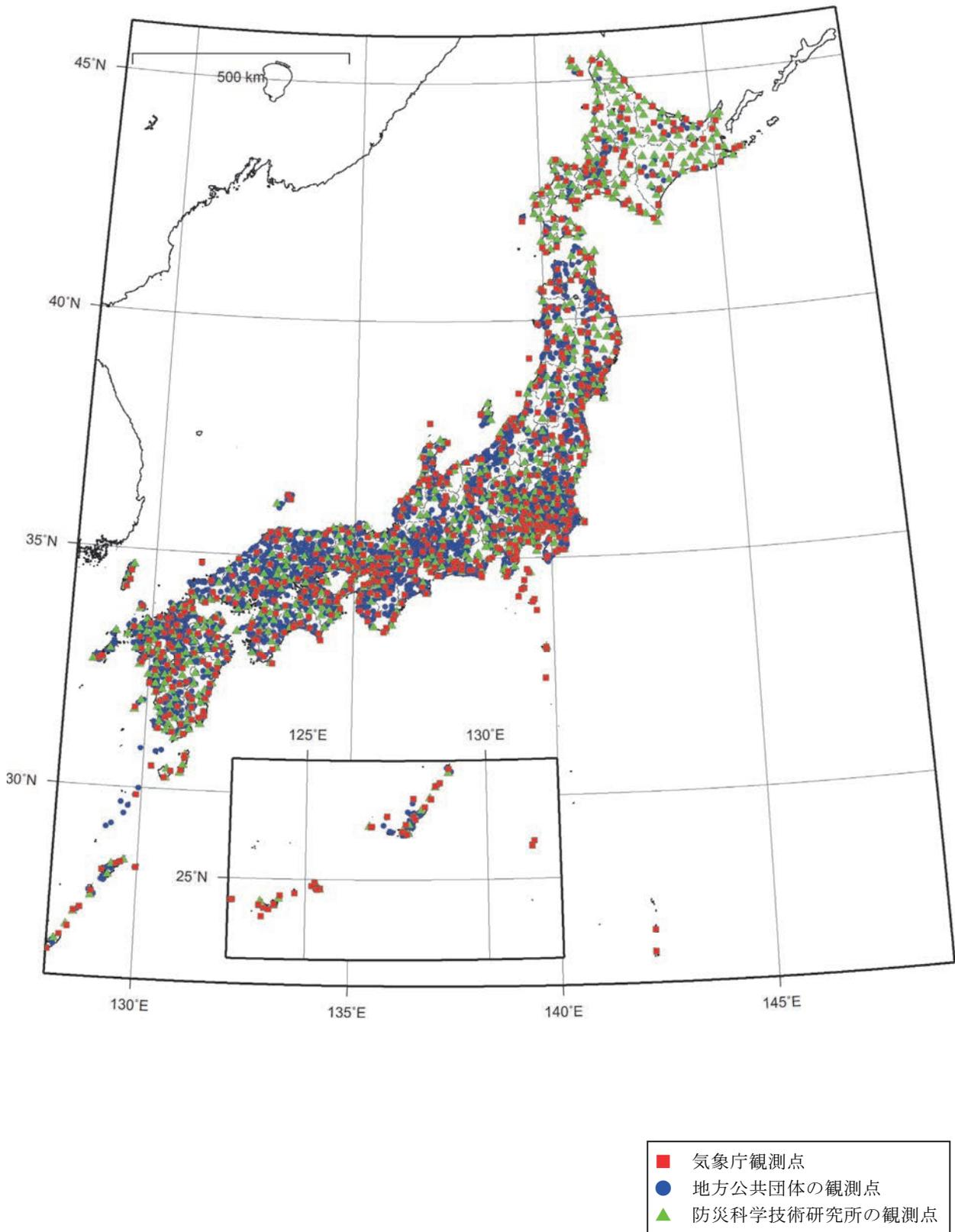
平成 27 年 11 月 26 日現在、気象庁の観測点（■印）は 670 点、地方公共団体の観測点（●印）は 2,932 点、国立研究開発法人防災科学技術研究所の観測点（▲印）は 782 点である。
