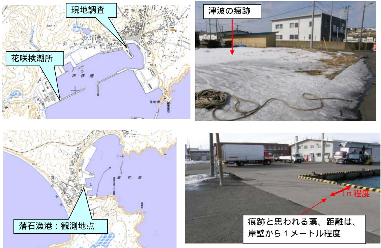
図 3 - 1 1 津波の高さを推定した地点の状況（上図：花咲港、下図：落石漁港）
