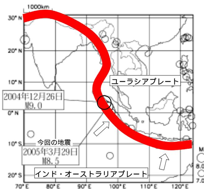
図 1 今回の地震の発生場所と周辺の地震表示した震央は、期間 1980 年 1 月から 2005 年 4 月 4 日までの深さ 100km 以浅、M7.0 以上の地震である。震源要素、マグニチュードは USGS の震源データによる。薄線は M5.0 以上の震央分布から推定したプレート境界線である。矢印はプレートのおおよその収束方向を示す。
