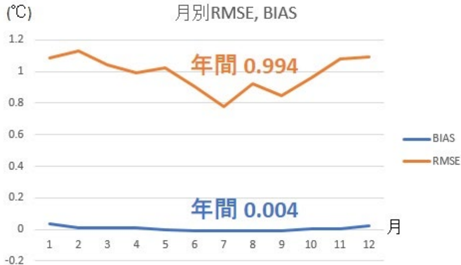
図 2 2020 年 1 年間の実験による気温分布の精度、アメダスの全観測地点における月別の RMSE と BIAS、当該地点の観測値を用いずに周囲の観測値から推計した値を観測値と比較しています。
