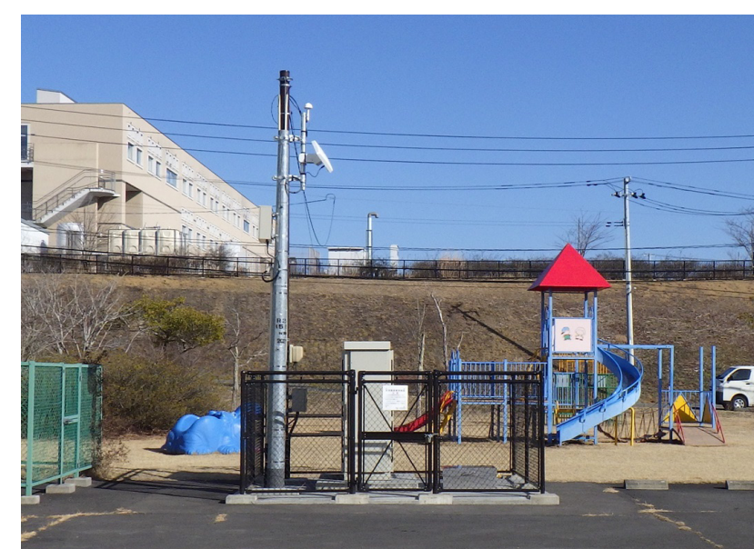
震度観測装置 （左：外観、右：加速度計）
