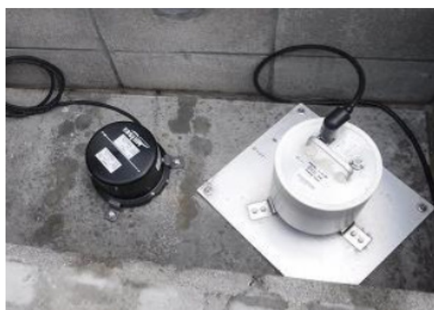
多機能型地震観測装置 （左：外観、右：加速度計、速度計）
