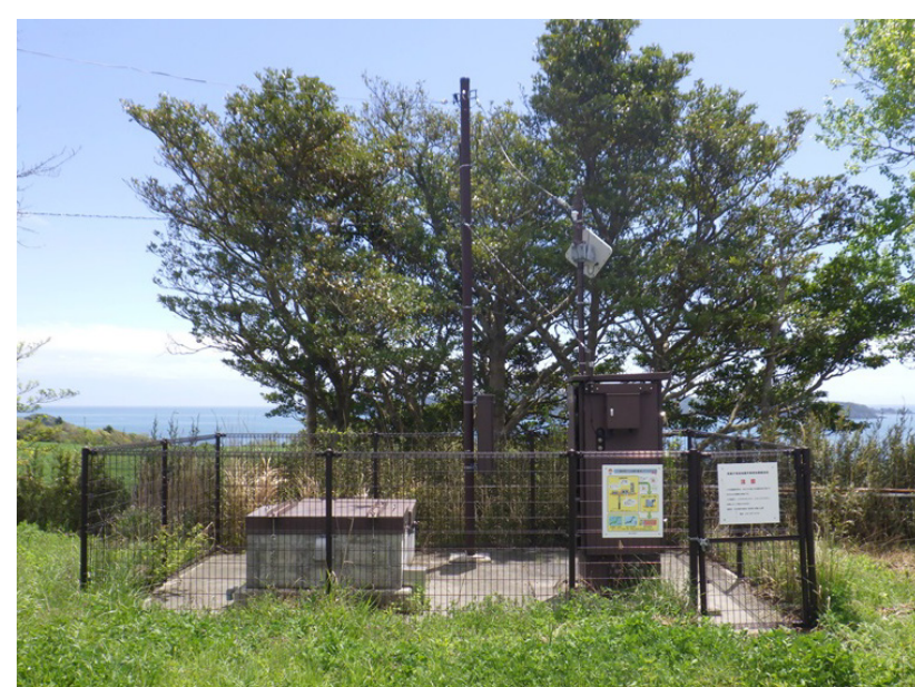
多機能型地震観測装置 （左：外観、右：加速度計、速度計）
