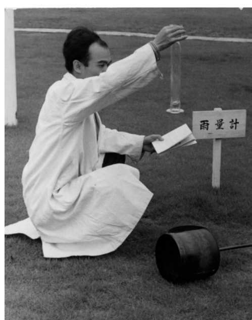
貯水型雨量計による観測
