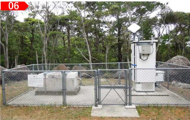
**06** 沖縄県内各地には、観測データを収集するため様々な観測地がある。写真は地震観測局である。多様な地震動(揺れの大小、周期の長短など)を観測するために、各種の地震計を設置している。
