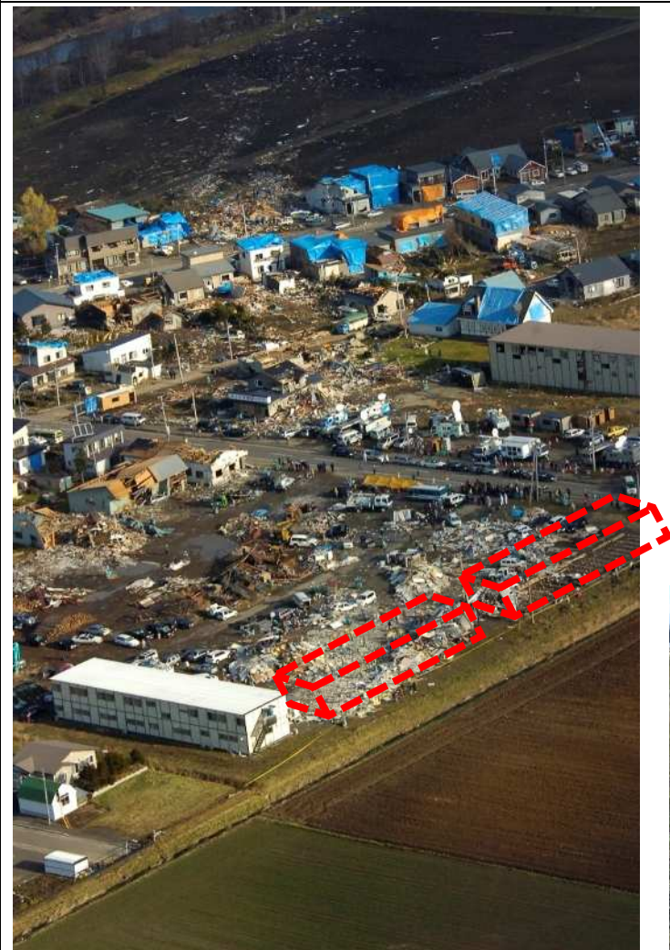
DOD=3 2階建て以上(2連以上)の転倒 手前の飛ばされていない仮設事務所と同じものが2棟(赤点線)飛ばされた。右図は飛ばされた仮設事務所の杭基礎の状況で、杭が引き抜けに対して抵抗した痕跡はない。 (2層以上の連棟で短辺長さが10m未満であるので代表値を採用する事例) 写真提供：(左)東京工芸大学風工学研究センター、(右)国立研究開発法人建築研究所
