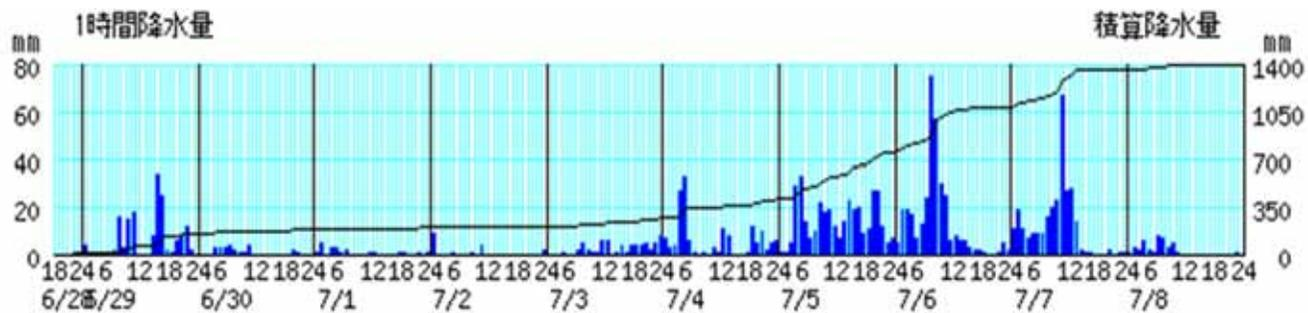
棒グラフは1時間降水量(左軸)、折れ線グラフは積算降水量(右軸)を示す。
