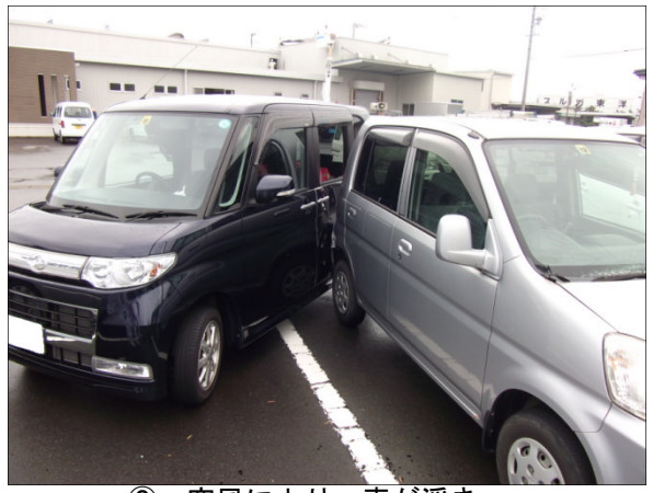
② 突風により、車が浮き上がって移動し、隣の車に接触した
