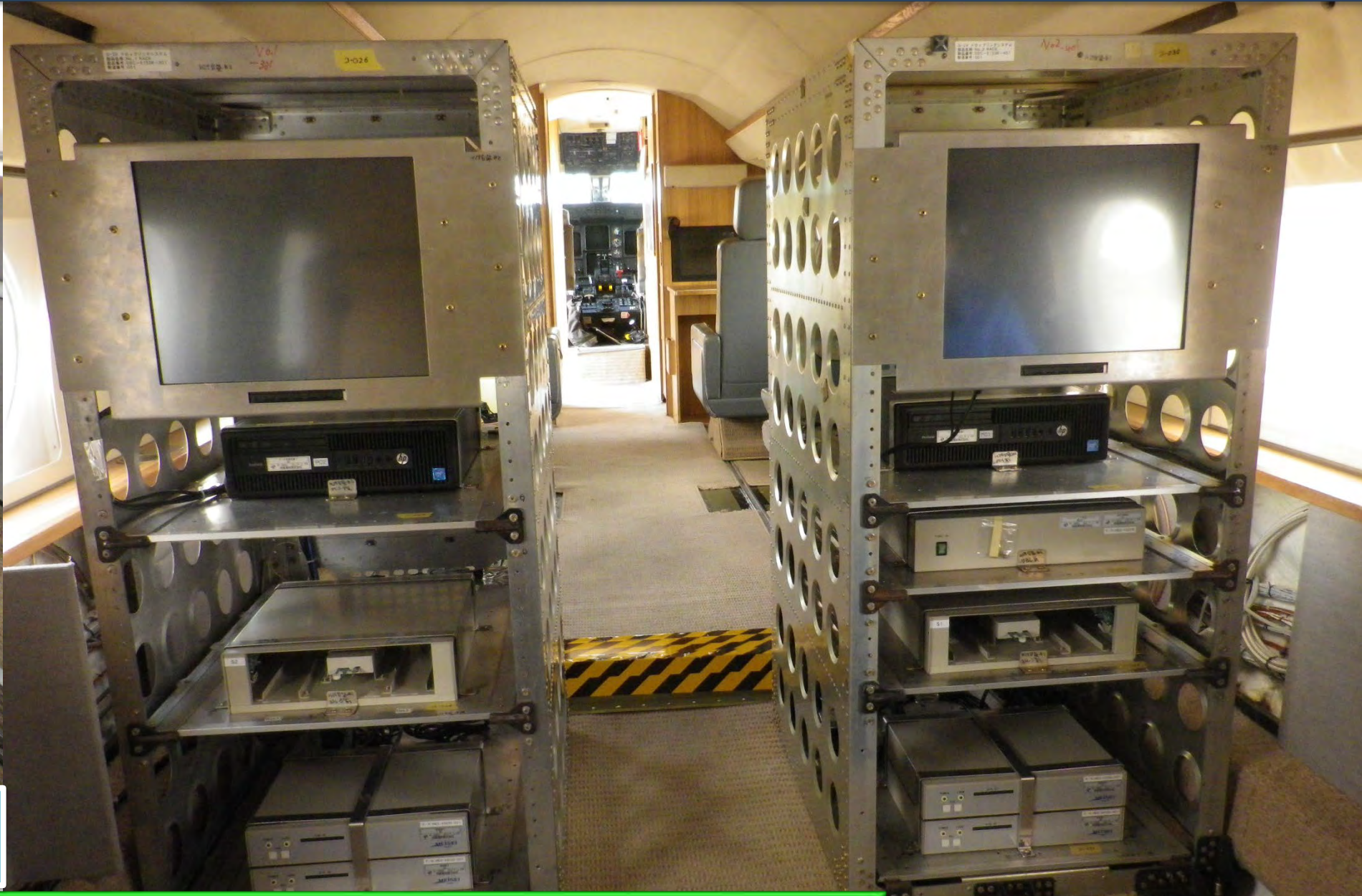
名古屋大学松尾総長(現機構長)の裁量経費で設置したドロップゾンデ投下装置
