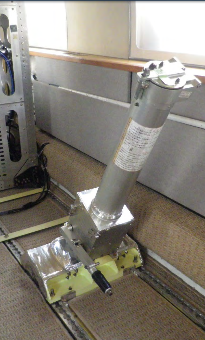
投下装置(下部ハンドルを回転してドロップゾンデを射出する)
