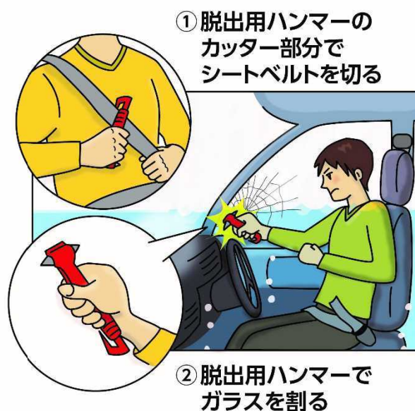
脱出用ハンマー、シートベルトカッターの使い方 (JAF ホームページより)
