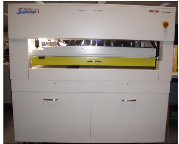
図6 写真原画フィルムを読み込む大型スキャナ「Scamera-1」(ニユーリー株式会社製)
