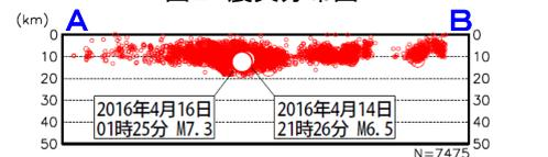
図3 断面図(A-B投影)
