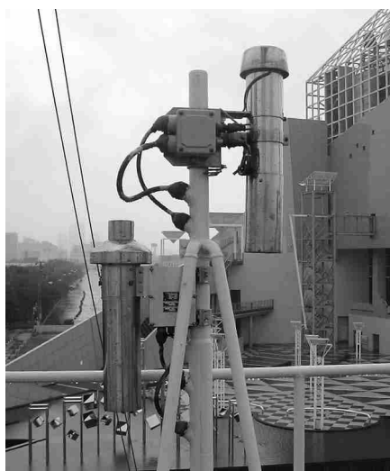
第3.4図 通風筒に納められた隔測温湿度計
