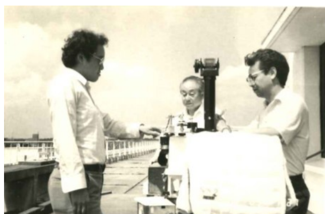
写真2 ドブソンオゾン分光光度計を調整している様子
