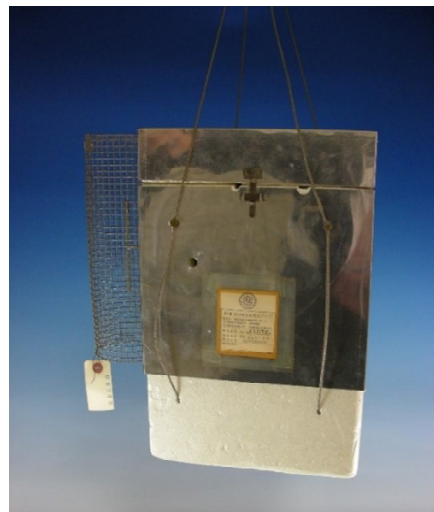
図 3.8.4 気象電気ゾンデ(E70 型)
