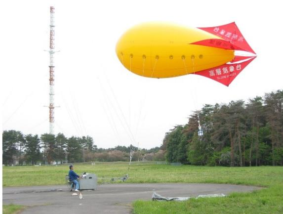
図 3.8.2 係留気球観測装置
