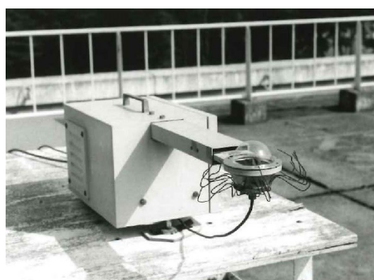
図 3.5.12 防風型通風式放射計
