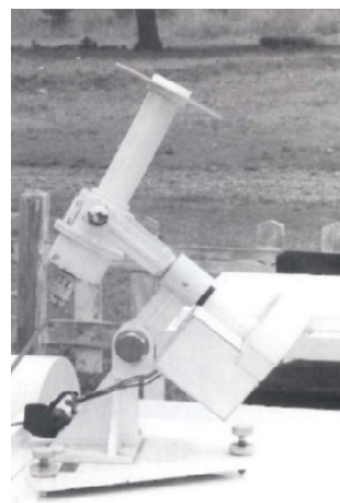
図 3.5.7 高層気象台型自記直達日射計(KOSO G-1)
