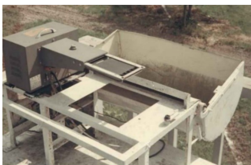
図 3.5.4 ギャ・ダンクル型放射計
