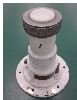
図 3.4.1 エプリー型の全天紫外線日射計
