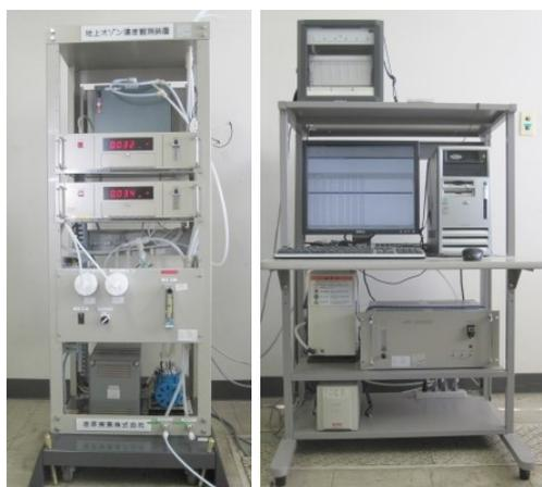
図 3.3.10 地上オゾン濃度観測装置の測定部(左)と処理部(右)
