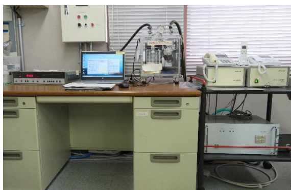
図 3.3.6 ポンプ効率測定装置
