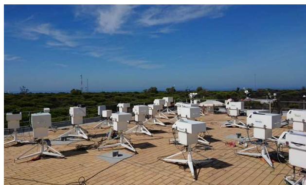
写真 1 ブリュウワー分光光度計相互比較の様子 2019 年 6 月 22 日, INTA El Arenosillo 実験センター屋上にて.
