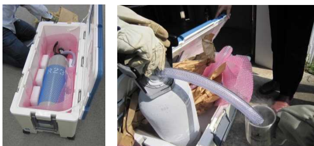
写真3 CFHに使用する冷媒の準備の様子
