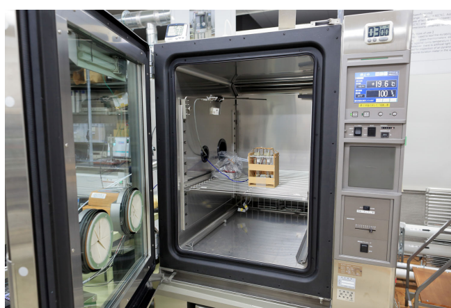
Photo 6 恒温槽の中の反応管設置状況
