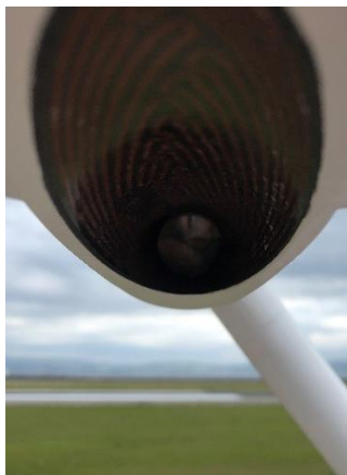
写真 3-1 正常な投光部レンズ面
