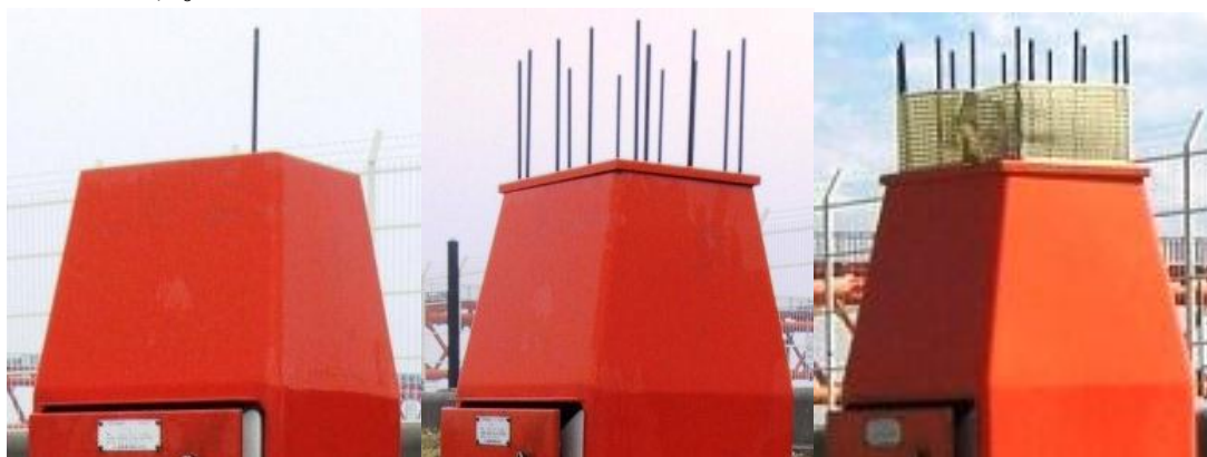
第5図 シーロメーター鳥除けの改良（左：設置当初、中：改良後、右：羽田対応）
