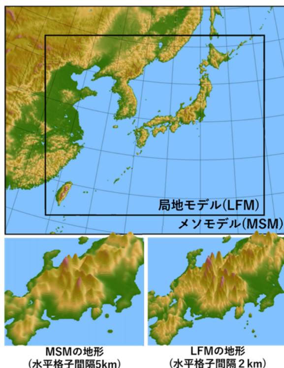
第 11 図 上図：MSM・LFM の計算領域 左下図：MSM の地形 右下図：LFM の地形
