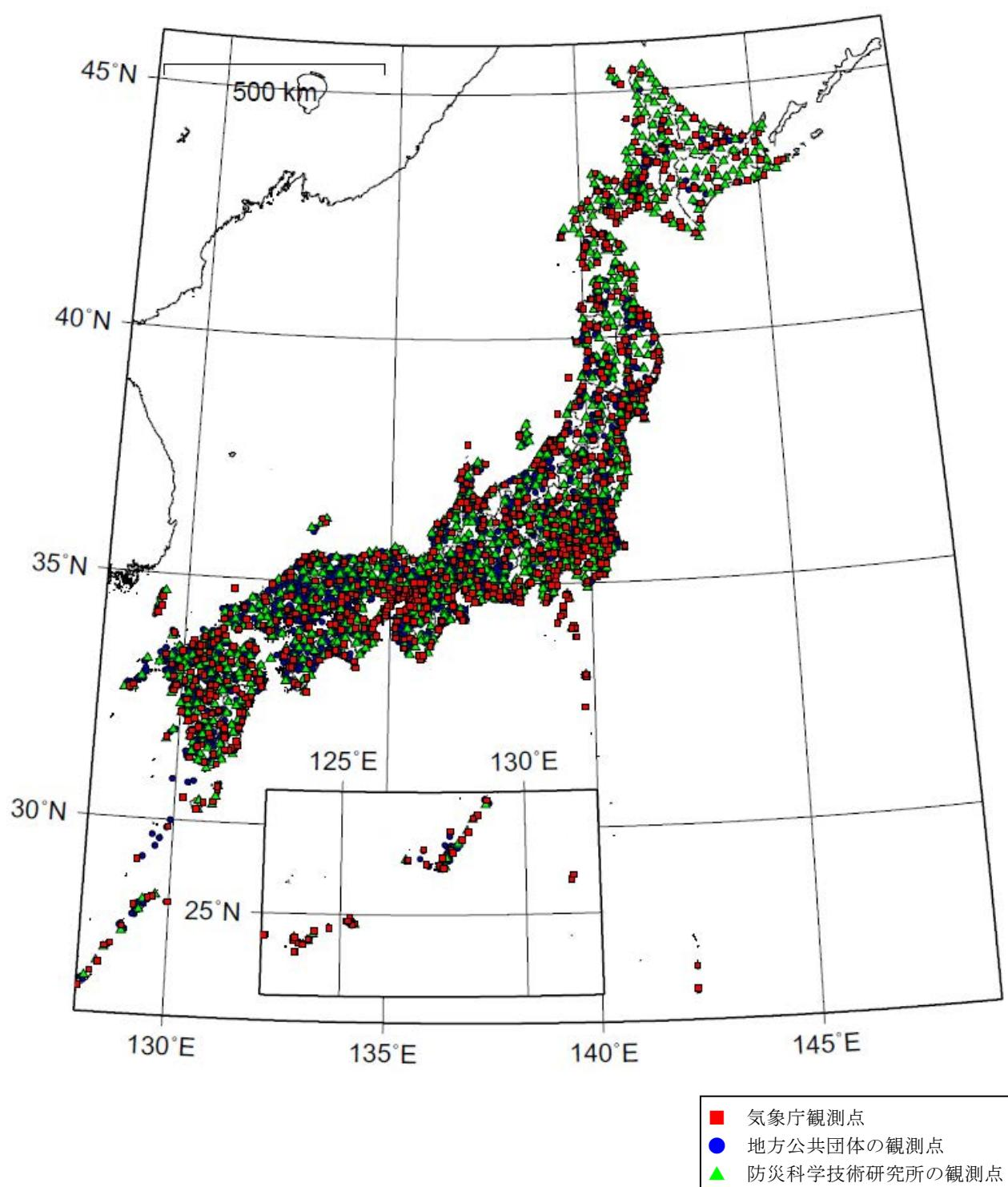
令和7年11月20日現在、気象庁の観測点（■印）は671点、地方公共団体の観測点（●印）は2,896点、国立研究開発法人防災科学技術研究所の観測点（▲印）は801点である。
