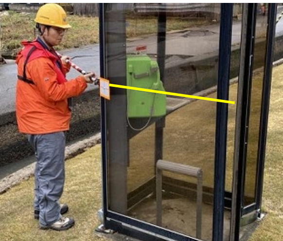
写真8-17：津波の痕跡（能登町九十九湾）
