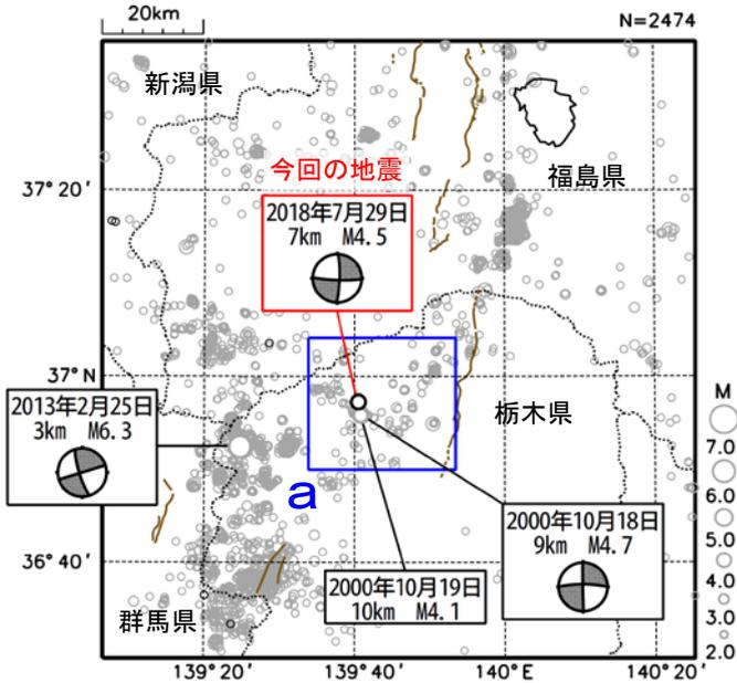
2018年7月29日09時58分に栃木県北部の深さ7kmでM4.5の地震(最大震度3)が発生した。この地震は地殻内で発生した。発震機構は、北西-南東方向に圧力軸を持つ横ずれ断層型である。この地震の発生以降、一時的にややまとまった地震活動がみられた。
