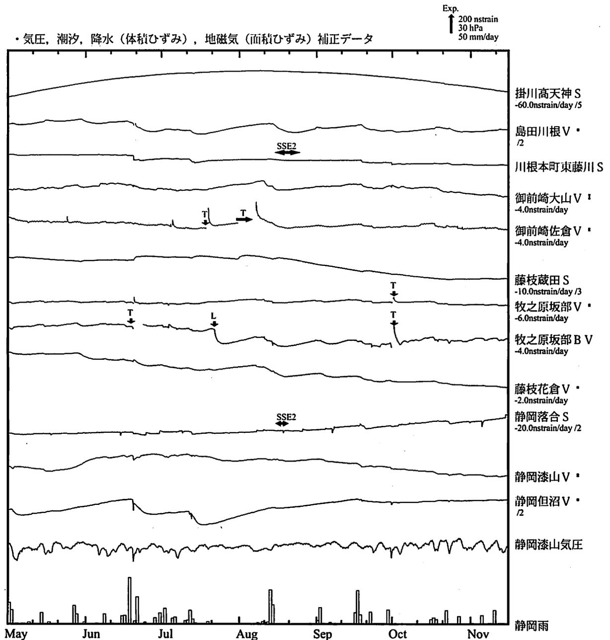
※観測点名の右側のスケールは、平常時に1日間で変動し得る最大の変化の幅(ノイズレベル)を示す。
