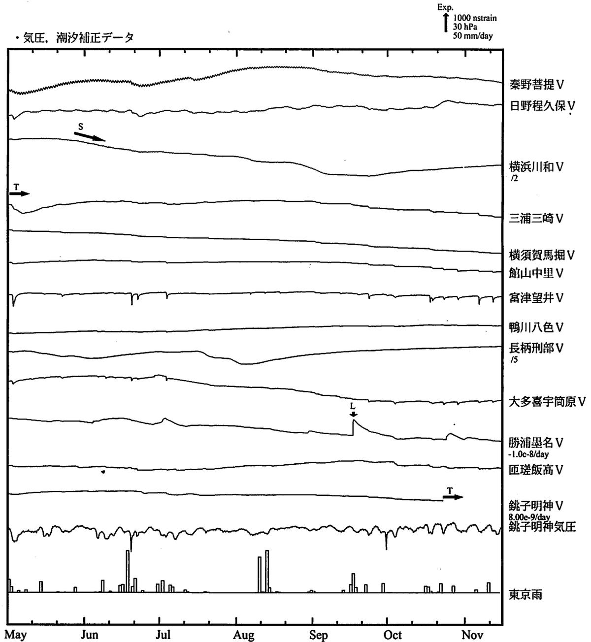
※観測点名の右側のスケールは、平常時に1日間で変動し得る最大の変化の幅(ノイズレベル)を示す。
