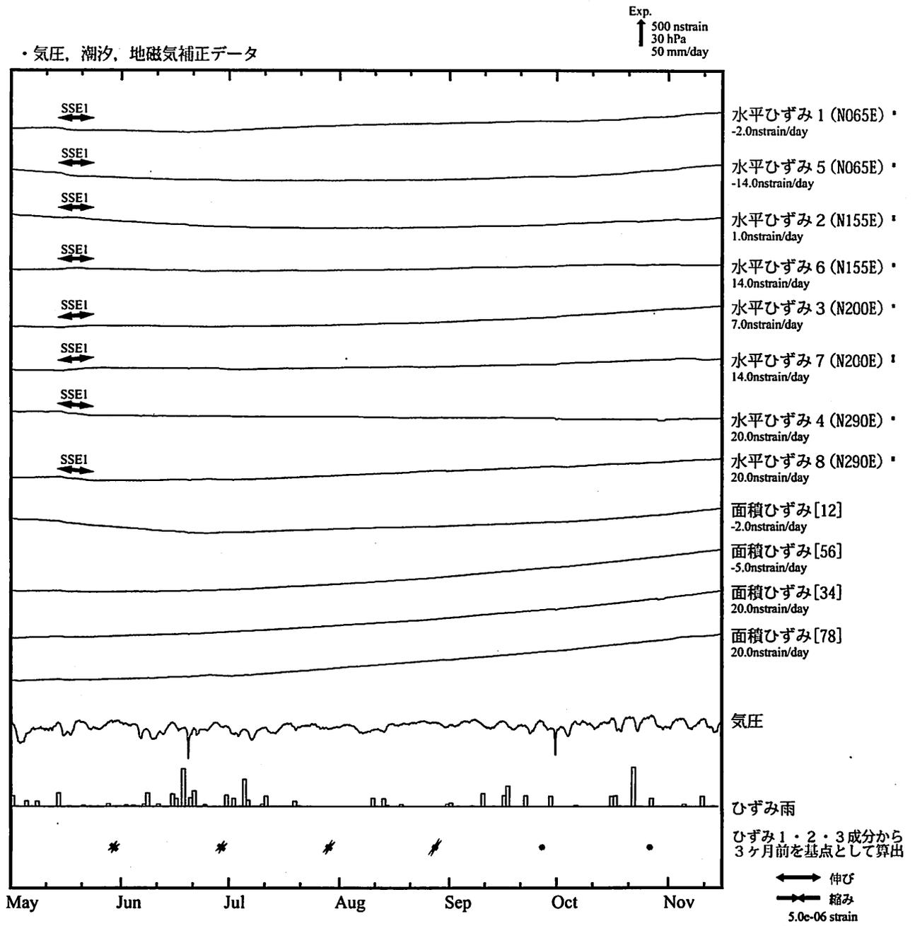
※観測点名の右側のスケールは、平常時に1日間で変動し得る最大の変化の幅(ノイズレベル)を示す。
