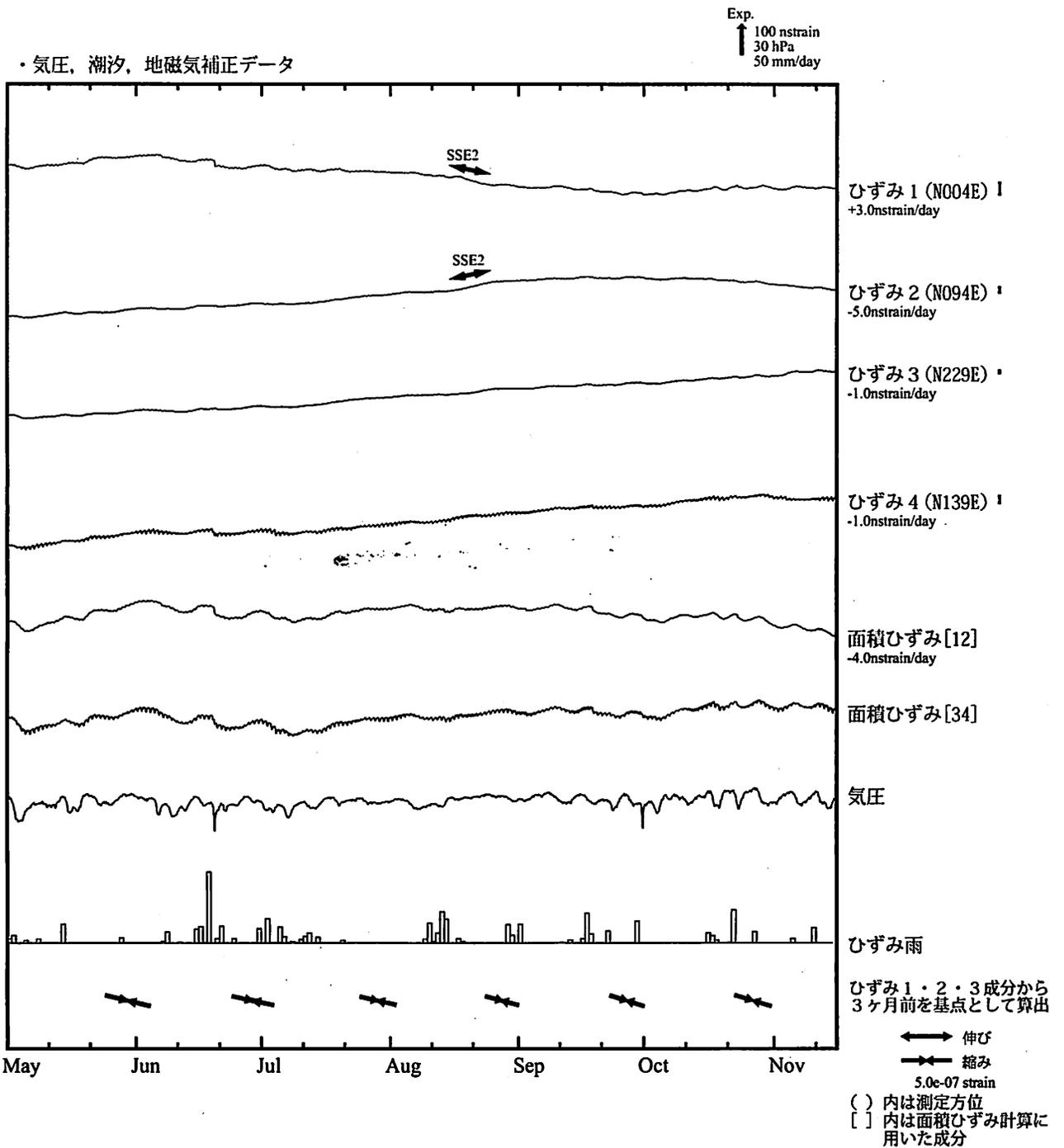
※観測点名の右側のスケールは、平常時に1日間で変動し得る最大の变化の幅(ノイズレベル)を示す。
