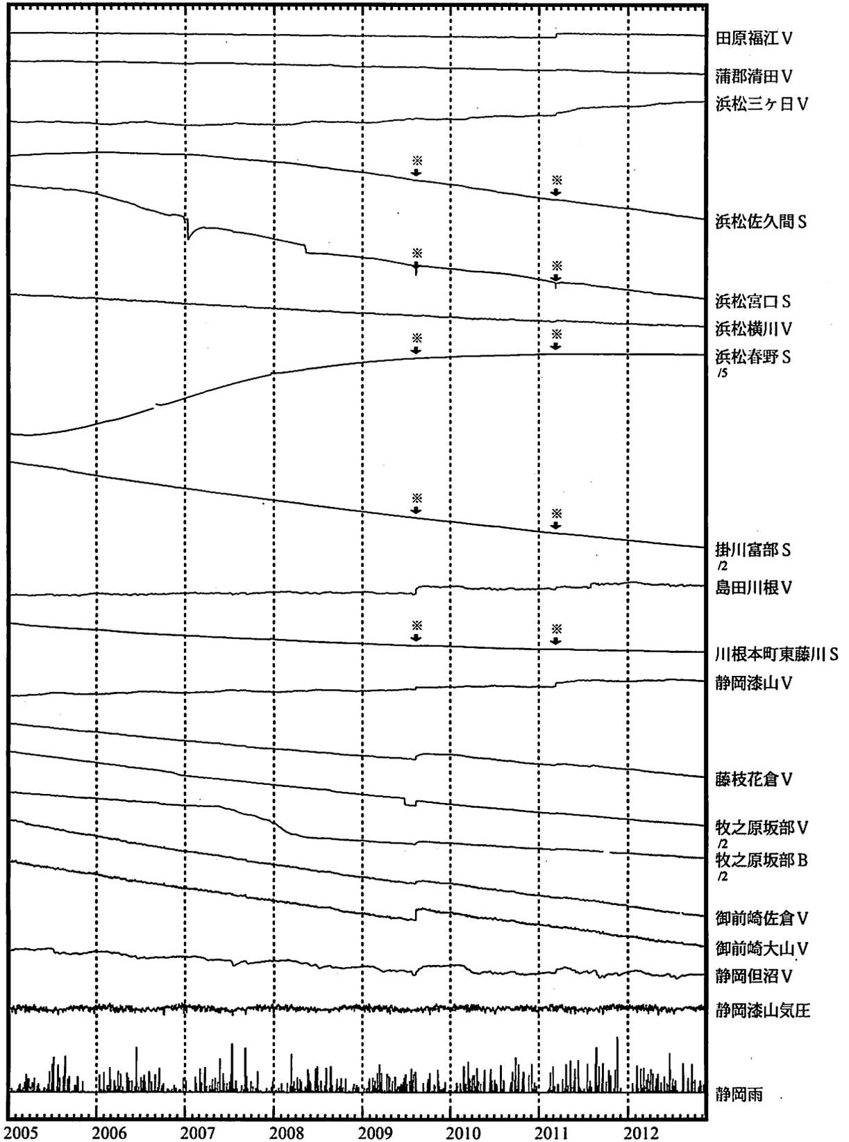
※面積ひずみは、東海道沖（紀伊半島南東沖）の地震、駿河湾の地震および東北地方太平洋沖地震に伴うステップ状の変化を除外して計算している。
