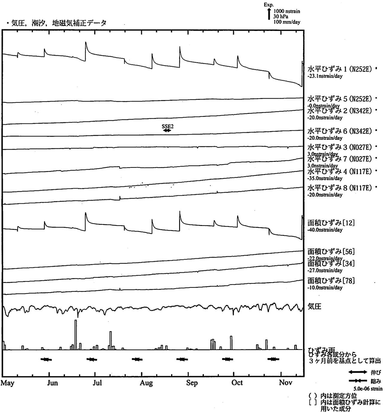
※観測点名の右側のスケールは、平常時に1日間で変動し得る最大の变化の幅(ノイズレベル)を示す。
