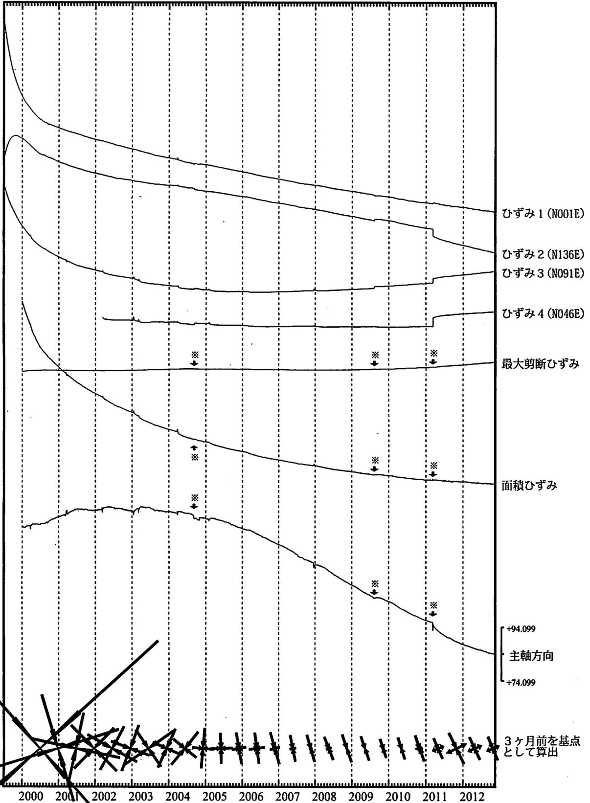
\*最大剪断ひずみ、面積ひずみおよび主軸方向は、東海道沖（紀伊半島南東沖）の地震、駿河湾の地震および東北地方太平洋沖地震に伴うコサイスマミックなステップを除去して計算している。
