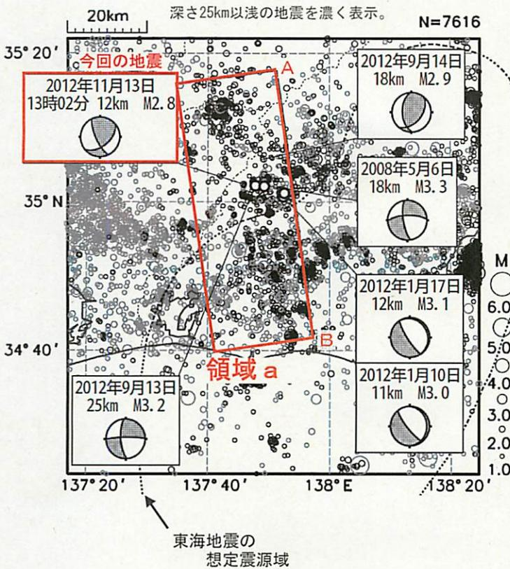
2012年11月13日13時02分に静岡県西部の深さ12kmでM2.8の地震(最大震度1)が発生した。この地震は地殻内で発生した。発震機構は、東西方向に圧力軸を持つ横ずれ断層型である。余震活動は観測されていない。
