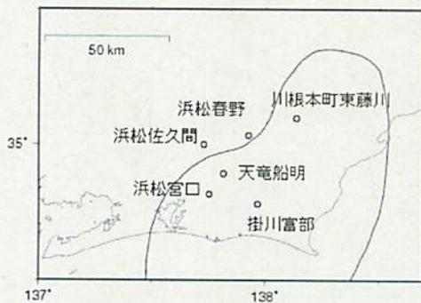
第 1 図 天竜船明（ふなぎら）観測点と多成分ひずみ計観測点の配置。
