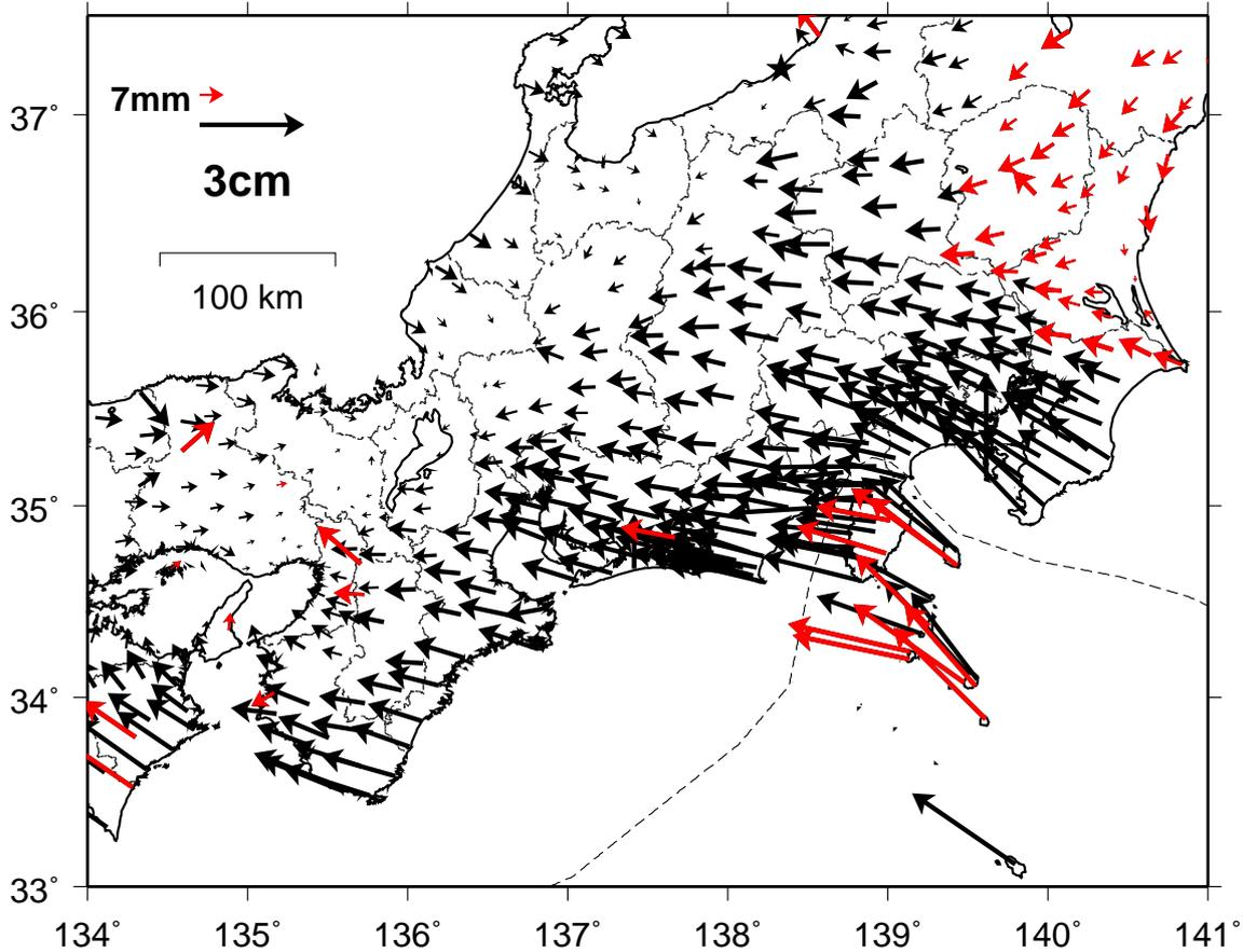
・スロースリップ開始前の変動速度ベクトル（左下図）との差の絶対値が 7 mm 以上の変動ベクトルを赤矢印で表示している。
