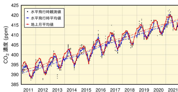
図 2.1-6 厚木航空基地—南鳥島間の航空機観測による水平飛行時（高度約 6km）に採取した大気中の二酸化炭素濃度（黒点）とその平均値（青点）及び南鳥島の地上における月平均二酸化炭素濃度（赤点）
