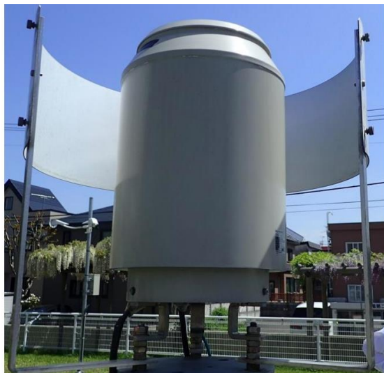
「温水式雨量計」の外観。外筒には不凍液が入っています。風よけの「助炭」の一部を取り外した状態です。
